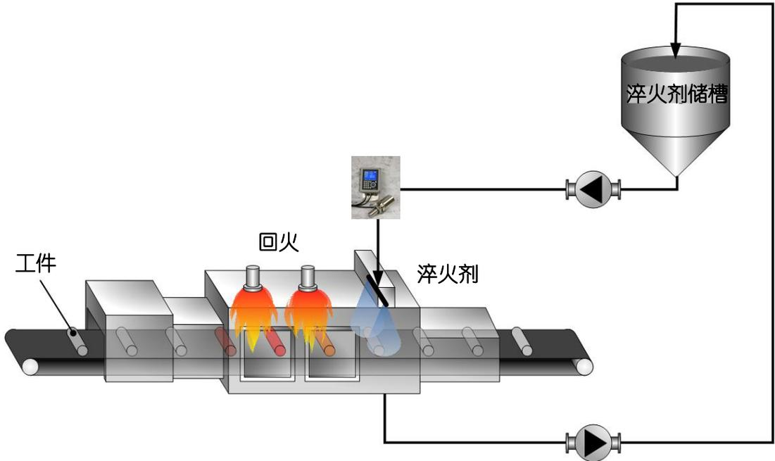
**EMC E-Scan**在线折光浓度仪，广泛应用于在线监测金属零部件加工过程中切削油、冷却液、淬火剂、清洗脱脂剂、表调剂、钝化剂等的浓度，以金属件回火/淬火工艺为例，E-Scan主要应用于以下工段。
